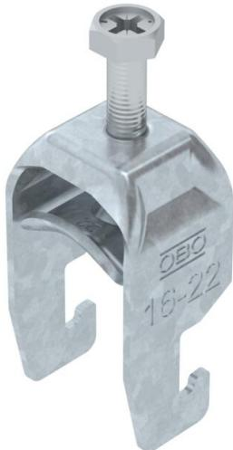
Abrazadera sobre perfil con base U, mediacaña metálica con bordes redondeados para proteger los cables. Para el montaje vertical y horizontal de 1 cable individual en perfil tipo C. Para ancho de ranura de 18 - 22 mm. Con tornillo de 1 paso en la mediacaña, cabeza de tornillo hexagonal universal SW10, con ranura y ranura en cruz. Adecuado para montaje en zonas interiores y exteriores. Se recomienda el uso de una contra-caña.
