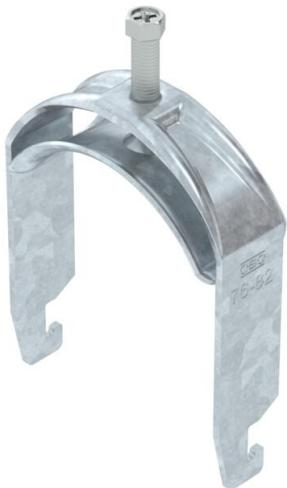
Abrazadera sobre perfil con base U, mediacaña metálica con bordes redondeados para proteger los cables. Para el montaje vertical y horizontal de 1 cable individual en perfil tipo C. Para ancho de ranura de 18 - 22 mm. Con tornillo de 1 paso en la mediacaña, cabeza de tornillo hexagonal universal SW10, con ranura y ranura en cruz. Adecuado para montaje en zonas interiores y exteriores. Se recomienda el uso de una contra-caña.
