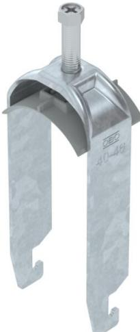
Abrazadera sobre perfil con base U, mediacaña de plástico de polipropileno. Para el montaje vertical y horizontal de 2 cables individuales en perfil tipo C. Para ancho de ranura de 18 - 22 mm. Con tornillo de 1 paso en la mediacaña, cabeza de tornillo hexagonal universal SW10, con ranura y ranura en cruz. Adecuado para montaje en zonas interiores y exteriores. Es conveniente separar varios cables mediante cañas dobles. Se recomienda el uso de una contra-caña.
