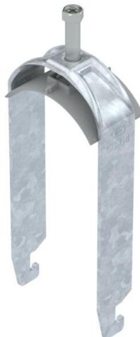
Abrazadera sobre perfil con base U, mediacaña de plástico de polipropileno. Para el montaje vertical y horizontal de 2 cables individuales en perfil tipo C. Para ancho de ranura de 18 - 22 mm. Con tornillo de 1 paso en la mediacaña, cabeza de tornillo hexagonal universal SW10, con ranura y ranura en cruz. Adecuado para montaje en zonas interiores y exteriores. Es conveniente separar varios cables mediante cañas dobles. Se recomienda el uso de una contra-caña.
