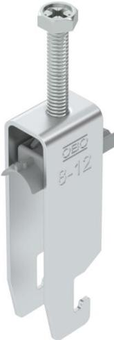
Abrazadera sobre perfil con base U, mediacaña de plástico de polipropileno. Para el montaje vertical y horizontal de 3 cables individuales en perfil tipo C. Para ancho de ranura de 18 - 22 mm. Con tornillo de 1 paso en la mediacaña, cabeza de tornillo hexagonal universal SW10, con ranura y ranura en cruz. Adecuado para montaje en zonas interiores y exteriores. Es conveniente separar varios cables mediante cañas dobles. Se recomienda el uso de una contra-caña.
