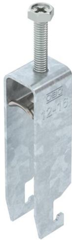
Abrazadera sobre perfil con base U, mediacaña metálica con bordes redondeados para proteger los cables. Para el montaje vertical y horizontal de 3 cables individuales en perfil tipo C. Para ancho de ranura de 18 - 22 mm. Con tornillo de 1 paso en la mediacaña, cabeza de tornillo hexagonal universal SW10, con ranura y ranura en cruz. Adecuado para montaje en zonas interiores y exteriores. Es conveniente separar varios cables mediante cañas dobles. Se recomienda el uso de una contra-caña.
