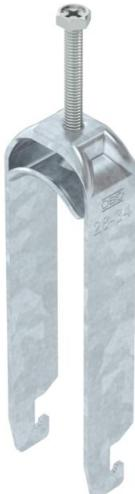
Abrazadera sobre perfil con base U, mediacaña metálica con bordes redondeados para proteger los cables. Para el montaje vertical y horizontal de 3 cables individuales en perfil tipo C. Para ancho de ranura de 18 - 22 mm. Con tornillo de 1 paso en la mediacaña, cabeza de tornillo hexagonal universal SW10, con ranura y ranura en cruz. Adecuado para montaje en zonas interiores y exteriores. Es conveniente separar varios cables mediante cañas dobles. Se recomienda el uso de una contra-caña.
