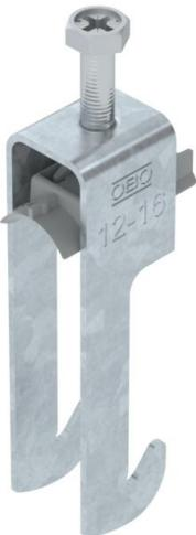
Abrazadera sobre perfil con base W, mediacaña de plástico de polipropileno. Para el montaje vertical y horizontal de 1 cable individual en perfiles angulares hasta < 40 mm. Con tornillo de 1 paso en la mediacaña, cabeza de tornillo hexagonal universal SW10, con ranura y ranura en cruz. Adecuado para montaje en zonas interiores y exteriores. Se recomienda el uso de una contra-caña.
