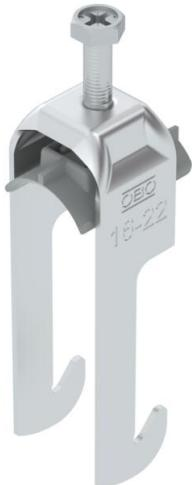
Abrazadera sobre perfil con base W, mediacaña de plástico de polipropileno. Para el montaje vertical y horizontal de 1 cable individual en perfiles angulares hasta < 40 mm. Con tornillo de 1 paso en la mediacaña, cabeza de tornillo hexagonal universal SW10, con ranura y ranura en cruz. Adecuado para montaje en zonas interiores y exteriores. Se recomienda el uso de una contra-caña.
