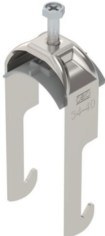
Abrazadera sobre perfil con base W, mediacaña de plástico de polipropileno. Para el montaje vertical y horizontal de 1 cable individual en perfiles angulares hasta < 40 mm. Con tornillo de 1 paso en la mediacaña, cabeza de tornillo hexagonal universal SW10, con ranura y ranura en cruz. Adecuado para montaje en zonas interiores y exteriores. Se recomienda el uso de una contra-caña.
