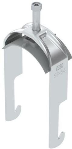
Abrazadera sobre perfil con base W, mediacaña de plástico de polipropileno. Para el montaje vertical y horizontal de 1 cable individual en perfiles angulares hasta < 40 mm. Con tornillo de 1 paso en la mediacaña, cabeza de tornillo hexagonal universal SW10, con ranura y ranura en cruz. Adecuado para montaje en zonas interiores y exteriores. Se recomienda el uso de una contra-caña.
