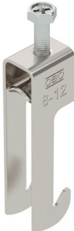
Abrazadera sobre perfil con base W, mediacaña metálica con bordes redondeados para proteger los cables. Para el montaje vertical y horizontal de 1 cable individual en perfiles angulares hasta < 40 mm. Con tornillo de 1 paso en la mediacaña, cabeza de tornillo hexagonal universal SW10, con ranura y ranura en cruz. Adecuado para montaje en zonas interiores y exteriores. Se recomienda el uso de una contra-caña.
