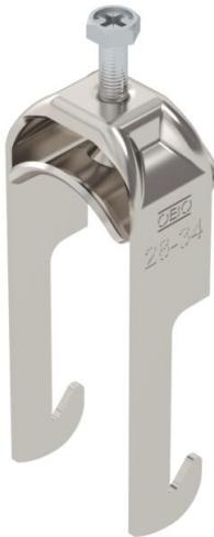
Abrazadera sobre perfil con base W, mediacaña metálica con bordes redondeados para proteger los cables. Para el montaje vertical y horizontal de 1 cable individual en perfiles angulares hasta < 40 mm. Con tornillo de 1 paso en la mediacaña, cabeza de tornillo hexagonal universal SW10, con ranura y ranura en cruz. Adecuado para montaje en zonas interiores y exteriores. Se recomienda el uso de una contra-caña.
