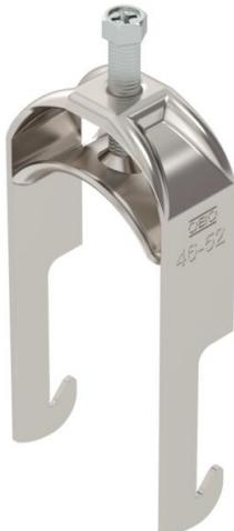
Abrazadera sobre perfil con base W, mediacaña metálica con bordes redondeados para proteger los cables. Para el montaje vertical y horizontal de 1 cable individual en perfiles angulares hasta < 40 mm. Con tornillo de 1 paso en la mediacaña, cabeza de tornillo hexagonal universal SW10, con ranura y ranura en cruz. Adecuado para montaje en zonas interiores y exteriores. Se recomienda el uso de una contra-caña.
