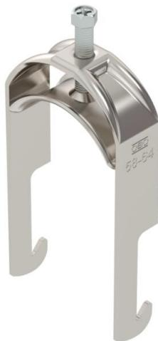
Abrazadera sobre perfil con base W, mediacaña metálica con bordes redondeados para proteger los cables. Para el montaje vertical y horizontal de 1 cable individual en perfiles angulares hasta < 40 mm. Con tornillo de 1 paso en la mediacaña, cabeza de tornillo hexagonal universal SW10, con ranura y ranura en cruz. Adecuado para montaje en zonas interiores y exteriores. Se recomienda el uso de una contra-caña.
