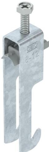
Abrazadera sobre perfil con base W, mediacaña de plástico de polipropileno. Para el montaje vertical y horizontal de 2 cables individuales en perfiles angulares hasta < 40 mm. Con tornillo de 1 paso en la mediacaña, cabeza de tornillo hexagonal universal SW10, con ranura y ranura en cruz. Adecuado para montaje en zonas interiores y exteriores. Es conveniente separar varios cables mediante cañas dobles. Se recomienda el uso de una contra-caña.
