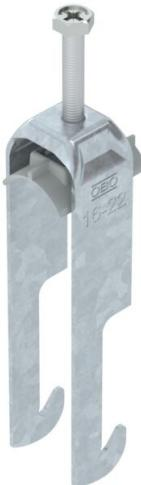
Abrazadera sobre perfil con base W, mediacaña de plástico de polipropileno. Para el montaje vertical y horizontal de 2 cables individuales en perfiles angulares hasta < 40 mm. Con tornillo de 1 paso en la mediacaña, cabeza de tornillo hexagonal universal SW10, con ranura y ranura en cruz. Adecuado para montaje en zonas interiores y exteriores. Es conveniente separar varios cables mediante cañas dobles. Se recomienda el uso de una contra-caña.
