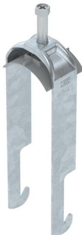
Abrazadera sobre perfil con base W, mediacaña de plástico de polipropileno. Para el montaje vertical y horizontal de 2 cables individuales en perfiles angulares hasta < 40 mm. Con tornillo de 1 paso en la mediacaña, cabeza de tornillo hexagonal universal SW10, con ranura y ranura en cruz. Adecuado para montaje en zonas interiores y exteriores. Es conveniente separar varios cables mediante cañas dobles. Se recomienda el uso de una contra-caña.
