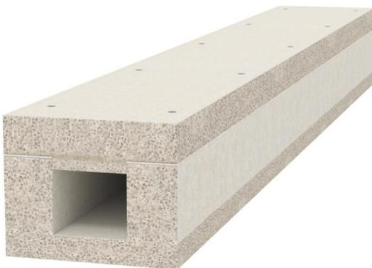
Canal de protección contra el fuego compuesto por hormigón ligero con fibra de vidrio, resistente al agua y a las heladas, de la clase de material de construcción A1 según 13501-1 para el tendido seguro contra incendios de cables en vías de evacuación y escape, y para mantener el funcionamiento de los sistemas relevantes para la seguridad. Clasificación I90 como canal I según DIN 4102 parte 11y clasificación E30 como canal E según DIN 4102 parte 12.
