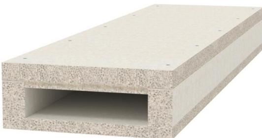
Canal de protección contra el fuego compuesto por hormigón ligero con fibra de vidrio, resistente al agua y a las heladas, de la clase de material de construcción A1 según 13501-1 para el tendido seguro contra incendios de cables en vías de evacuación y escape, y para mantener el funcionamiento de los sistemas relevantes para la seguridad. Clasificación I90 como canal I según DIN 4102 parte 11y clasificación E30 como canal E según DIN 4102 parte 12.
