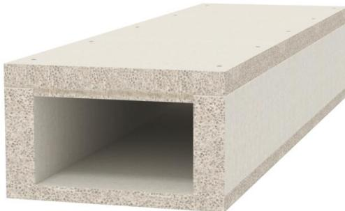
Canal de protección contra el fuego compuesto por hormigón ligero con fibra de vidrio, resistente al agua y a las heladas, de la clase de material de construcción A1 según 13501-1 para el tendido seguro contra incendios de cables en vías de evacuación y escape, y para mantener el funcionamiento de los sistemas relevantes para la seguridad. Clasificación I90 como canal I según DIN 4102 parte 11y clasificación E30 como canal E según DIN 4102 parte 12.
