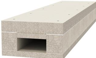
Canal de protección contra el fuego compuesto por hormigón ligero con fibra de vidrio, resistente al agua y a las heladas, de la clase de material de construcción A1 según 13501-1 para el tendido seguro contra incendios de cables en vías de evacuación y escape, y para mantener el funcionamiento de los sistemas relevantes para la seguridad. Clasificación I120 como canal I según DIN 4102 parte 11y clasificación E90 como canal E según DIN 4102 parte 12.
