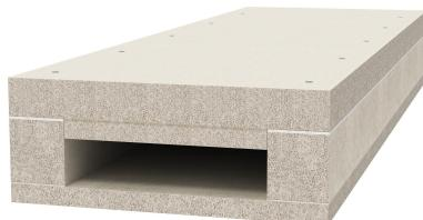
Canal de protección contra el fuego compuesto por hormigón ligero con fibra de vidrio, resistente al agua y a las heladas, de la clase de material de construcción A1 según 13501-1 para el tendido seguro contra incendios de cables en vías de evacuación y escape, y para mantener el funcionamiento de los sistemas relevantes para la seguridad. Clasificación I120 como canal I según DIN 4102 parte 11y clasificación E90 como canal E según DIN 4102 parte 12.
