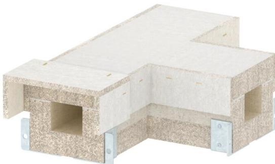
Pieza en T para canal de protección contra el fuego PYROLINE® Con S, tipo BSKH09-K0506 compuesto por hormigón ligero con fibra de vidrio, resistente al agua y a las heladas para la realización de derivaciones en T a lo largo del canal. Los conectores montados aseguran un montaje rápido in situ, mientras que las cubiertas colocadas sin apretar garantizan una inspección y reasignación rápidas.
