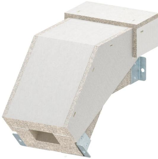
Curva vertical descendente para canal de protección contra el fuego PYROLINE® Con S, tipo BSKH09-K0506 compuesto por hormigón ligero con fibra de vidrio, resistente al agua y a las heladas para la realización de cambios de sentido verticales (45°) a lo largo del canal. Los conectores montados aseguran un montaje rápido in situ, mientras que las cubiertas colocadas sin apretar garantizan una inspección y reasignación rápidas.
