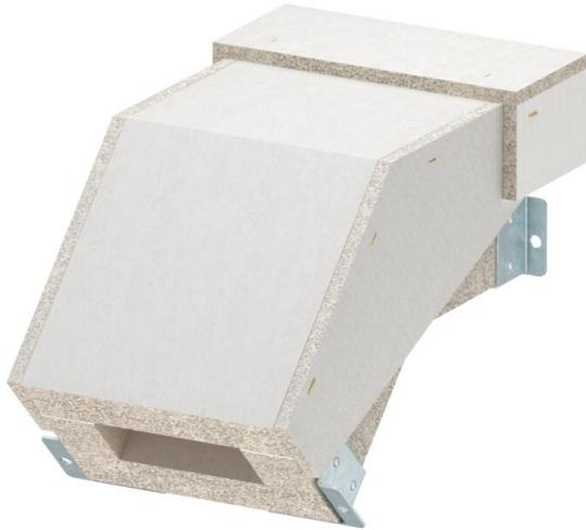
Curva vertical descendente para canal de protección contra el fuego PYROLINE® Con S, tipo BSKH09-K0511 compuesto por hormigón ligero con fibra de vidrio, resistente al agua y a las heladas para la realización de cambios de sentido verticales (45°) a lo largo del canal. Los conectores montados aseguran un montaje rápido in situ, mientras que las cubiertas colocadas sin apretar garantizan una inspección y reasignación rápidas.
