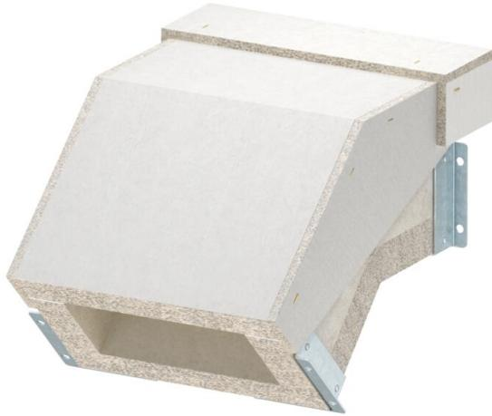
Curva vertical descendente para canal de protección contra el fuego PYROLINE® Con S, tipo BSKH09-K1021 compuesto por hormigón ligero con fibra de vidrio, resistente al agua y a las heladas para la realización de cambios de sentido verticales (45°) a lo largo del canal. Los conectores montados aseguran un montaje rápido in situ, mientras que las cubiertas colocadas sin apretar garantizan una inspección y reasignación rápidas.
