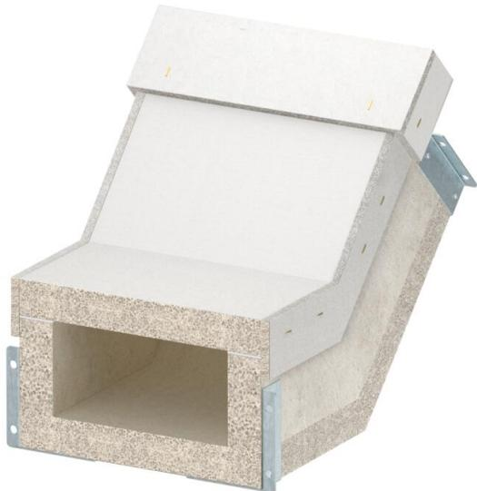
Curva vertical ascendente para canal de protección contra el fuego PYROLINE® Con S, tipo BSKH09-K1021 compuesto por hormigón ligero con fibra de vidrio, resistente al agua y a las heladas para la realización de cambios de sentido verticales (45°) a lo largo del canal. Los conectores montados aseguran un montaje rápido in situ, mientras que las cubiertas colocadas sin apretar garantizan una inspección y reasignación rápidas.
