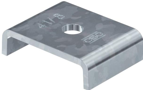
Componente para el montaje de varillas roscadas en perfiles de montaje MS4141P y MS4121P. Para el montaje de sistemas de bandejas portacables y bandejas de rejilla por encima de techos colgantes de protección contra incendio en vías de evacuación y escape. En caso de incendio impide que se doblen los perfiles de montaje. Apropiado para varillas roscadas M8, M10 y M12. Ninguna arandela adicional necesaria.
