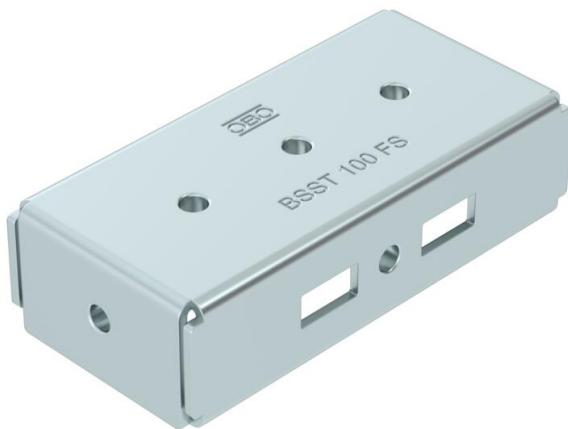
Travesaño del apoyo simétrico para el sistema BKRS, adecuado para parte inferior, tipo BSSU 190 1010. Se puede utilizar para bandejas portacables transitables, ancho de 100 mm. Con pasajes roscados para el montaje sin virutas de bandejas portacables. Fijación en parte inferior con 4x tornillo de cabeza avellanada FKS M6. El material de fijación se debe pedir por separado.
