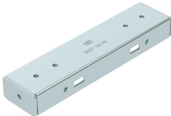
Travesaño del apoyo simétrico para el sistema BKRS, adecuado para parte inferior, tipo BSSU 190 2030. Se puede utilizar para bandejas portacables transitables, ancho de 200 mm. Con pasajes roscados para el montaje sin virutas de bandejas portacables. Fijación en parte inferior con 4x tornillo de cabeza avellanada FKS M6. El material de fijación se debe pedir por separado.
