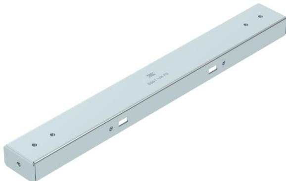
Travesaño del apoyo simétrico para el sistema BKRS, adecuado para parte inferior, tipo BSSU 190 4060. Se puede utilizar para bandejas portacables transitables, ancho de 400 mm. Con pasajes roscados para el montaje sin virutas de bandejas portacables. Fijación en parte inferior con 4x tornillo de cabeza avellanada FKS M6. El material de fijación se debe pedir por separado.
