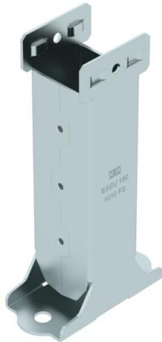
Parte inferior del apoyo simétrico para el sistema BKRS, adecuado para travesaño, tipo BSST 100. Se puede utilizar para bandejas portacables transitables, ancho de 100 mm. Con pasajes roscados para el montaje de componentes de conexión, por ejemplo, abrazaderas para tubo, y con agujeros alargados para montaje en suelo hasta M10. El material de fijación se debe pedir por separado.
