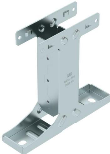
Parte inferior del apoyo simétrico para el sistema BKRS, adecuado para travesaño, tipo BSST 200/300. Se puede utilizar para bandejas portacables transitables, ancho de 200 o 300 mm. Con pasajes roscados para el montaje de componentes de conexión, por ejemplo, abrazaderas para tubo, y con agujeros alargados para montaje en suelo hasta M10. El material de fijación se debe pedir por separado.
