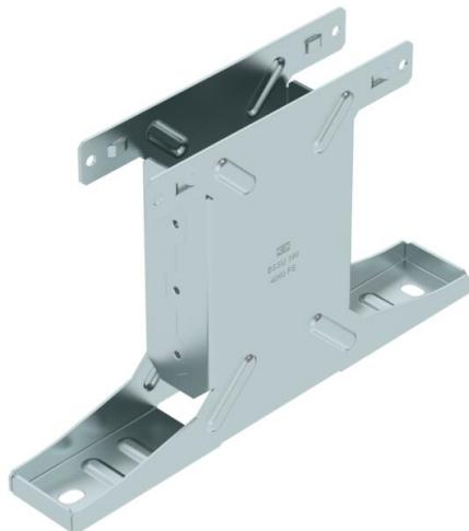
Parte inferior del apoyo simétrico para el sistema BKRS, adecuado para travesaño, tipo BSST 400/500/600. Se puede utilizar para bandejas portacables transitables, ancho de 400-600 mm. Con pasajes roscados para el montaje de componentes de conexión, por ejemplo, abrazaderas para tubo, y con agujeros alargados para montaje en suelo hasta M10. El material de fijación se debe pedir por separado.
