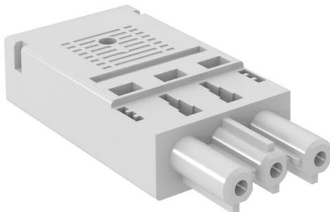
Conecotor hembra de 3 polos, tipo GST18i con conexión de fuerza elástica para cable rígido de 1,5 - 2,5 mm<sup>2</sup>, unifilar o soldado por ultrasonido, cables de hilo fino 1,5 mm<sup>2</sup> con casquillos terminales de hilo, sin montar con descarga de tracción, confeccionalbe in situ, 250 V, 16 A.
