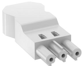
Conecotor hembra de 3 polos, tipo GST18i con racor roscado para cables de 1,5 - 4,0 mm<sup>2</sup> y diámetros de cable de 10,5 - 14,5 mm (H05VV, NYM), sin montar con descarga de tracción, confeccionalbe in situ, 250 V, 16 A.
