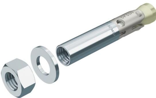
Anclaje de perno BZ-IG con rosca interior para el anclaje de cargas semipesadas a pesadas, así como en hormigón agrietado o sin grietas. Combina cargas elevadas permitidas con distancias reducidas de bordes y ejes. No es necesaria una sección trasera de los orificios.
