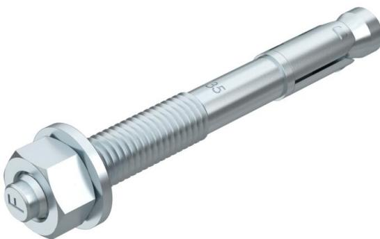
Anclaje con pernos BZ para el anclaje de cargas medias y pesadas, así como en hormigón fisurado y no fisurado. Combina elevadas cargas permitidas con distancias reducidas de borde y ejes.
