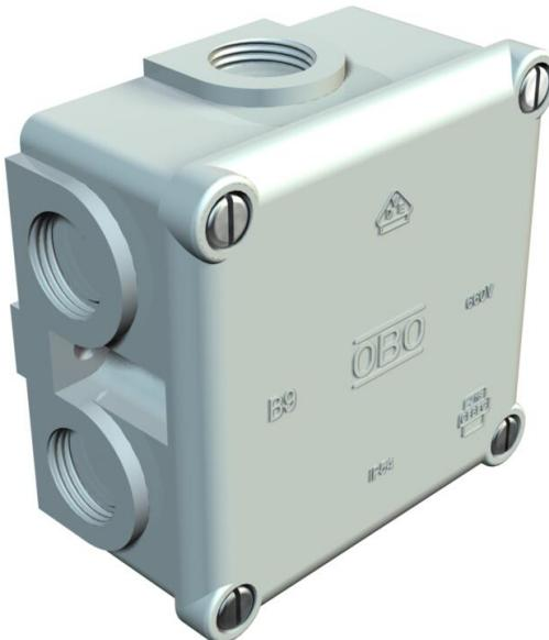
Grado de protección IP54, tensión nominal 660 V, sección nominal 2,5 - mm<sup>2</sup>, 2 orificios de fijación para tornillos de hasta 5 mm de Ø en la parte exterior de la caja, 4 tornillos de tapa, 7 Entradas rompibles con rosca M20 x 1,5, preferible para prensaestopas con rosca de conexión corta.
