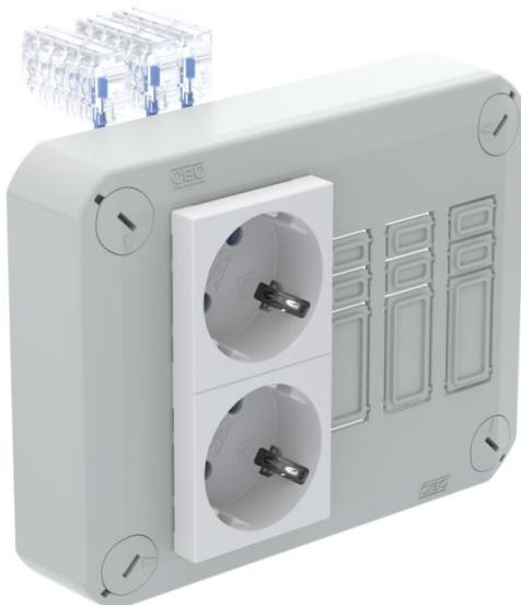
Tapa enchufable para cerrar cajas de derivación de cables, equipada con 2 tomas Modul 45 y precableada con terminales de conexión de palanca. Con cierre rápido sellable en la tapa. Material sin halógenos, resistente a la radiación UV. Antiinflamable según DIN EN 60695-2-11, temperatura de ensayo 650 °C. Resistencia al impacto IK07 a temperatura ambiente. Grado de protección IP30.
