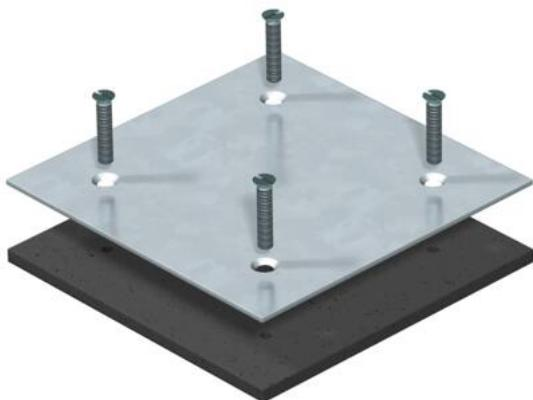
Placa ciega de tapa para cerrar la abertura de montaje DAT durante un montaje posterior. Con junta de goma para garantizar la protección contra la humedad según DIN EN 50085-2-2, con tornillos de fijación incluidos.
