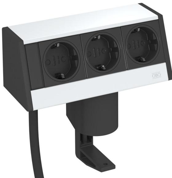
Deskbox con cable de conexión, salida de cable por la parte inferior del perfil, con un pie de fijación para tableros de mesa con un grosor de entre 8 y 40 mm.
