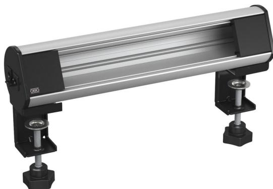
Deskbox DBL listo para conectar en la alimentación directa de puestos de trabajo con conexiones eléctricas. Con una conexión Wieland GST18® desde la izquierda fuera del perfil. Montaje sin herramientas con dos mordazas de fijación para tableros con grosor de 8 a 40 mm con mordazas de fijación estándar y de 40 a 70 mm con las mordazas de fijación DBZ-BZL70. El Deskbox no está equipado y puede equiparse con hasta 5 sistemas de instalación del modelo Modul 45®.
