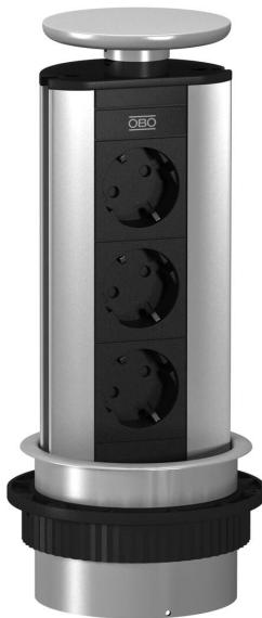
Deskbox extraíble con cable de conexión, para el montaje fijo en un tablero de mesa, manguito de unión de plástico, lacado en el mismo color que la tapa. El montaje se realiza perforando un orificio (102 mm Ø) en el tablero de la mesa.
