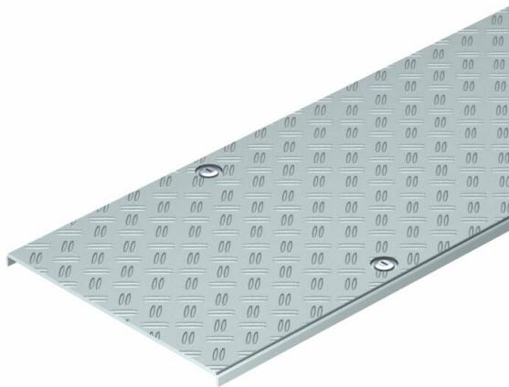
Tapa de bandeja portacables para el sistema de bandejas portacables transitable BKRS. Tapa redonda galvanizada en banda con espesor de material de 2 mm con chapa de aluminio estriada remachada como muestra Duo con un espesor de material de 4 mm, antideslizante y resistente a las pisadas. Fijación de tornillo giratorio con una distancia de tornillo giratorio de 500 mm. Cuando se utilizan las tapas en el exterior deben aplicarse medidas adicionales contra el viento.
