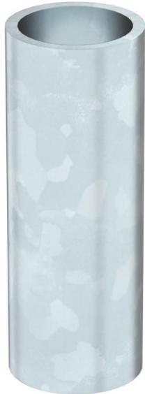
Los casquillos distanciadores para el montaje de soportes de suspensión bajo techos aislados evitan que el aislamiento quede presionado al apretar los tornillos de fijación.
