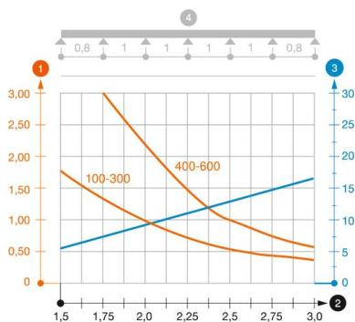
Diagrama de carga bandeja de chapa tipo DKS 60
