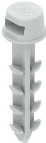
Taco de expansión Delta-Push® para el montaje en la instalación eléctrica. Adecuado para hormigón, ladrillo de cal y arena, ladrillo macizo, ladrillo perforado y hormigón celular. Montaje a presión sin herramientas en pared o techo. Sin tornillos. Con alojamiento de bridales para cables hasta 4,8 mm de anchura y 2 mm de altura para la fijación de cables y tubos.
