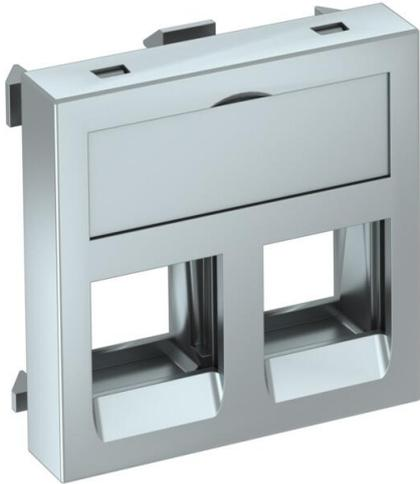
Soporte de datos con salida recta, sin deslizante de cierre, para alojar dos módulos de conexión de datos con toma RJ45. Se puede instalar tanto vertical como horizontalmente. El tipo C tiene una abertura de montaje de 19,30 x 14,80 mm y está diseñado para la fijación directa de los módulos de conexión de datos en la abertura de montaje.
